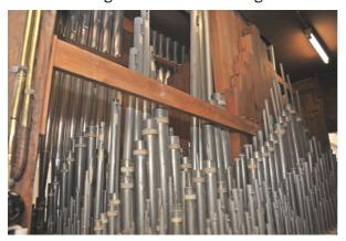
Risse im Holz, wo die Luft andere Wege geht, mitunter in eine andere Pfeife. Dann müssen die Filze erneuert werden. Die Schleifenanschläge der Register sind abgenutzt. Die Pfeifenmündungen und Stimmrollen müssen gerichtet bzw. erneuert werden. Eine Reinigung der Windladen von innen ist notwendig. Die unterschiedliche Spielbarkeit der beiden Manuale soll angeglichen werden. Alle Pfeifen müssen von innen und außen gereinigt werden und ebenso alle Gehäuseteile, bis hin zur Schimmelbeseitigung.
